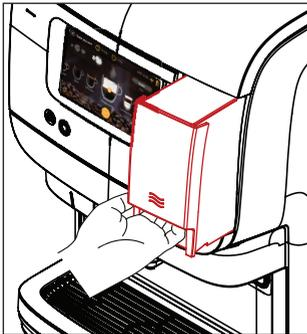
1. Den Wassertank am Griff an der Vorderseite greifen. Den Tank leicht nach oben drücken und gerade herausziehen.
