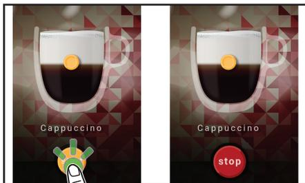
Fig. 4.7 - START e STOP erogazione bevanda
