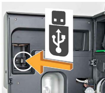
La mise à jour et la sauvegarde du logiciel sont effectuées avec une clé USB sur la JDE Barista ONE. Le port USB se trouve à l'intérieur de la porte de maintenance.
