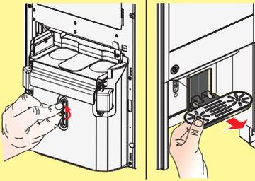
Das Rädchen aufschrauben, das die äußere Abtropfschale befestigt und die äußere Abtropfschale mit einem feuchten Tuch reinigen.
