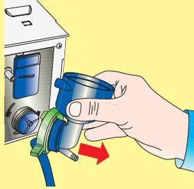
Die Mischbecher und -leitungen, das Ablasssystem und die Mischplatten entnehmen.
