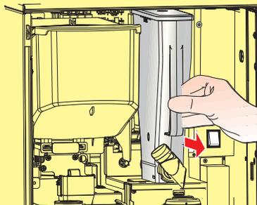
Die Auslassröhren der Instantbehälter durch Hochschieben der Röhren schließen. Die Behälter herausziehen.
