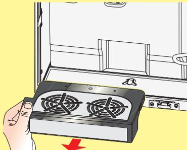
Die Abtropfschale entfernen. Den Deckel entfernen und die Abtropfschale entleeren. Den Sensor am Deckel reinigen.
