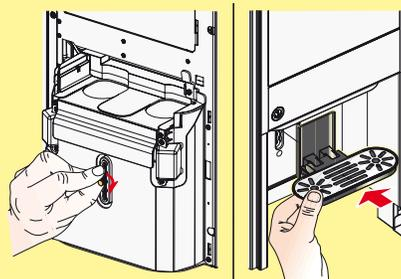
Die äußere und innere Abtropfschale wieder einsetzen.
