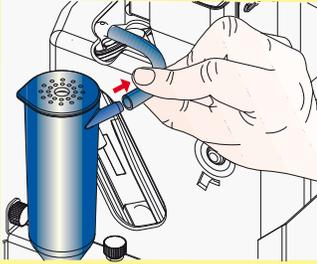
Die Heißwasser- und Aufschäumerschläuche entnehmen, diese vom vorderem Arm entfernen, den Verteiler von der Düsenhalterung entfernen.
