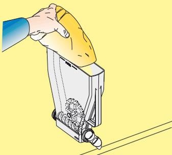
Die Behälter auf einen Tisch stellen, die Deckel öffnen und dann mit den Produkten füllen. Die Behälter vor dem Zurückschieben in den Automaten von außen reinigen.
