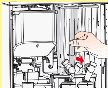
Den Produktausgang nach oben ziehen und dann den Instantbehälter entnehmen (einen nach dem anderen).
