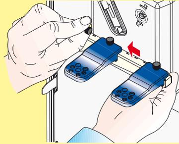
Die Düsenhalterungen wieder einsetzen und die Leiste an der Maschine befestigen. Den Aufschäumer wieder mit seinen Schläuchen an der Düsenhalterung anbringen.
