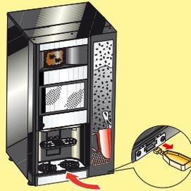
Das HACCP-Unterlagen ausfüllen. Den gelben Schlüssel abziehen, die Tür schließen und in Betrieb nehmen.
