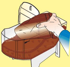
Den Produktbeutel aufschneiden, den Kaffee einfüllen und die Deckel schließen. Die Außenseite des Behälters vor dem Zurückschieben in den Automaten von außen reinigen. Das Innere des Kaffeebehälters einmal monatlich reinigen.
