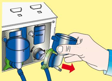
Die Mischbecher und -Leitungen, das Ablasssystem und die Mischplatten entnehmen.
