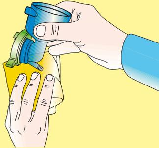
Die Abtropfschale für Düsen, den Mixerkopf und die Ablasssystemteile trocknen.
