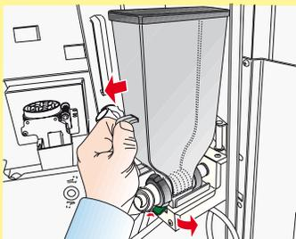
Den Zuckerbehälter entfernen: nach oben drehen, nach außen ziehen und dann den grünen Hebel unten drücken. Auf einen Tisch setzen
