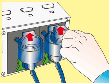
Den Kopf der Mischbecher entfernen, diese einsprühen, mit einem Tuch reinigen und den Kopf der Mischbecher wieder einsetzen.
