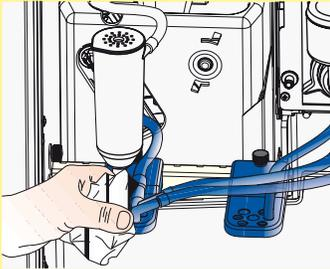
Die Düsenhalterung reinigen. Darauf achten, dass die Düsen sich in der korrekten Position befinden.
