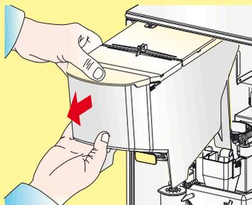
Die Kaffeeausgaben zu den Mahlwerken schließen und die Kaffeebehälter in die Füllposition gleiten lassen und den Deckel öffnen.
