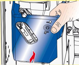
Die getrockneten Teile wieder einbauen. Auf die korrekte Positionierung der Schläuche achten.
