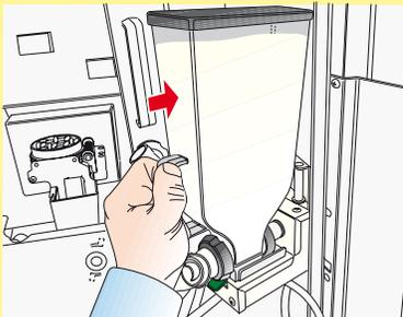
Den Zuckerbehälter wieder einsetzen und darauf achten, dass der grüne Hebel mit einem Klicken einrastet.
