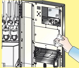
Die Innen- und Außenseite der Tür mit einem feuchten Tuch reinigen.
