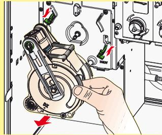
Alle Schläuche, die Brüherabdeckung und den Trichter für das Kaffeepulver entfernen. Den Brüher entfernen.
