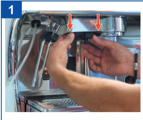
Den Cappuccinatore mit beiden Händen leicht andrücken und dann nach unten ziehen bis sich der Verankerung sich aus der Trageschiene löst.
