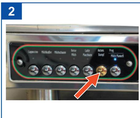
Die Autosteamertaste drücken (goldfarbig) und warten bis der automatische Aufwärmzyklus beendet ist. Nun die Lanze ca. 5 Minuten in warmen Wasser einweichen lassen und zum Schluss die Milchreste entfernen.
