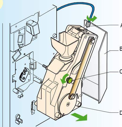
**Reinigen der Brühinheit:**
