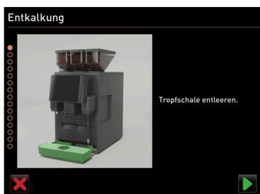
Figura: Vaciar el recogegotas
