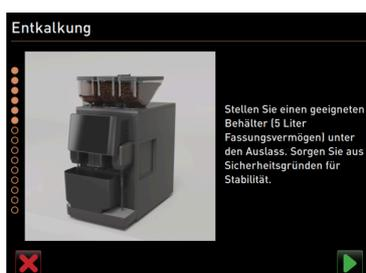
Figura: Colocar el depósito bajo máquina
