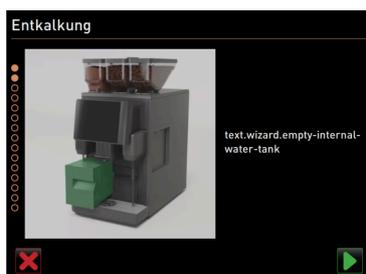
Figura: Vaciar el depósito de agua interno
