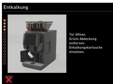
Figura: Colocar el cartucho de descalcificación
