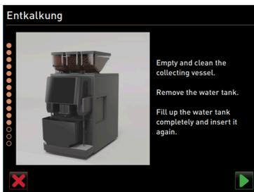
Figura: Retirar el depósito
