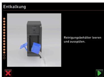
Figura: Retirar el depósito de limpieza
