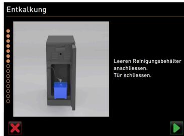
Figura: Colocar el depósito de limpieza
