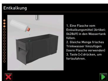
Figura: Rellenar descalcificador líquido
