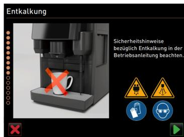
Figura: Iniciar el proceso de descalcificación
