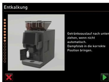
Figura: Posicionar la salida de bebida y la barra de vapor
