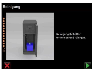
Figura: Extraer el depósito de limpieza
