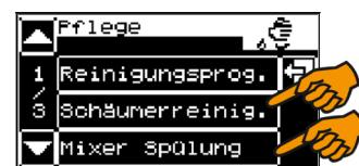
Schäumerreinigung und Mixer Spülung können separat durchgeführt werden.
