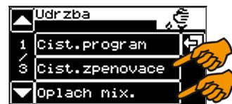
Čištění zpenovače a vymytí mixéru lze provádět samostatně.
