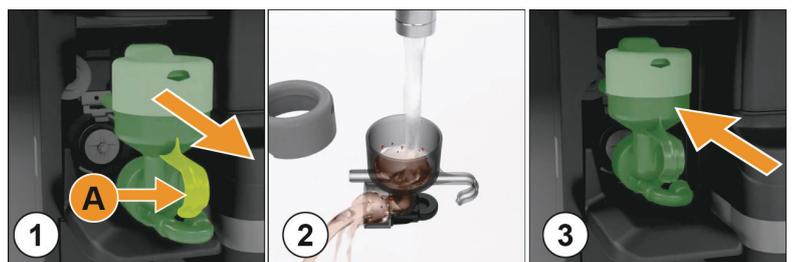
**ATTENTION:** Une cup du mélangeur non correctement mise en place peut provoquer un débordement.
