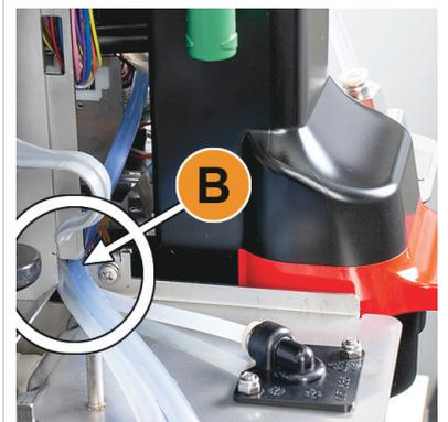
**Montar el revestimiento derecho y la guía del tubo flexible izquierda**
