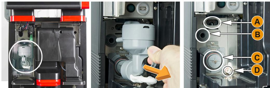
Fig.: Desmonte el vaso de mezcla
