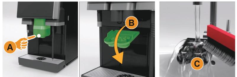
図: 飲料注出口下部カバーの取り外し
