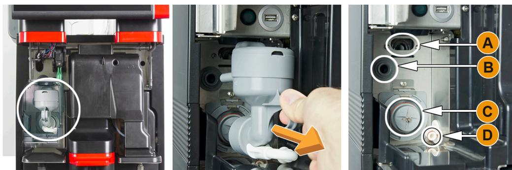
図: ミキサーカップを取り外します
