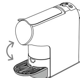
**Рис. 5В.** Регулировка положения подноса для чашек: большие чашки.
