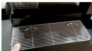
Leeren Sie die Tropfschale und den Abfallbehälter. Mit einem feuchten, sauberen Handtuch reinigen.
