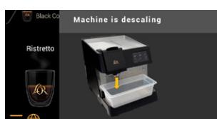
La machine démarrera le programme de détartrage (20 min).
