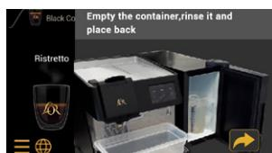
Leeg de houder. Spoel en plaats terug. Het apparaat zal het reinigingsprogramma voortzetten.
