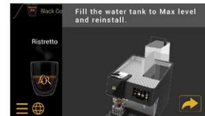
Remplissez le réservoir d'eau jusqu'au niveau Max., puis remettez-le en place.
