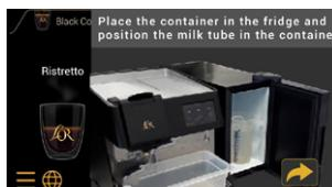
Stellen Sie den Behälter mit der Reinigungslösung in das Kühlabteil und führen Sie den Milchschauch in den Behälter ein.
