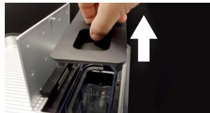
Abra la tapa del depósito de agua y retire la tapa de él.
