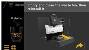
Leeren und reinigen Sie den Abfallbehälter und setzen Sie ihn anschließend wieder ein.
