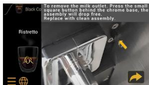
Appuyez sur le bouton de déverrouillage situé derrière l'orifice chromé de sortie du lait, puis retirez l'assemblage de l'orifice.
