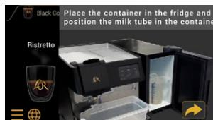
Placez le récipient avec la solution de nettoyage dans l'unité frigorifique et déposez le tuyau de lait dans le récipient.
