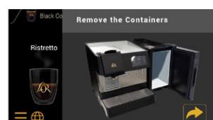
Entfernen Sie die Behälter aus dem Kühlabteil sowie die Tassenablage.
