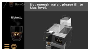
En cas de quantité d'eau insuffisante dans le réservoir au cours du processus de détartrage, un message vous demandant de remplir le réservoir s'affichera.
