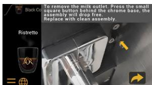
Drücken Sie den Entriegelungsknopf hinter dem verchromten Milchauslass und entfernen Sie die Auslasseinheit.
