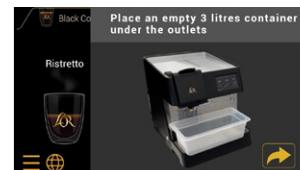
Placez un récipient vide d'une contenance de 3 litres sous les orifices.
