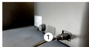
Conecte el cable de alimentación (1) a la máquina y enchúfelo a una toma de corriente.
