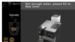
Si no hay suficiente agua en el depósito correspondiente durante el proceso de descalcificación, un mensaje en la pantalla le pedirá que rellene dicho depósito.
