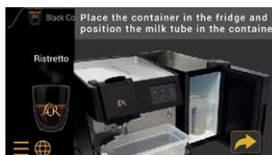
Zet de houder met reinigingsoplossing in de koelkast en plaats de melkslang in de container.
