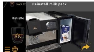
Haal de 1-literkan uit de koelkast en zet het pak melk in de koelkast. Stop het slangje in het pak melk.
