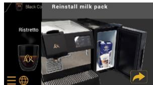
Nehmen Sie den 1-Liter-Behälter aus dem Kühlabteil und stellen Sie die Milchpackung in das Kühlabteil. Führen Sie den Schlauch in die Milchpackung ein.
