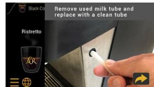
Entfernen Sie den Milchschauch und ersetzen Sie ihn durch einen sauberen Schlauch.
