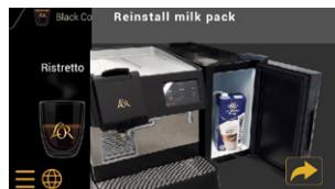
Sortez le récipient d'un litre de l'unité frigorifique et placez la brique de lait dans l'unité frigorifique. Placez le tuyau dans la brique de lait.
