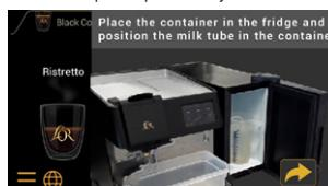
Nádobu s čisticím roztokem vložte do chladničky a trubici na mléko zasuňte do nádoby.
