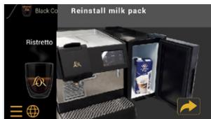
Stellen Sie die Milchpackung wieder in das Kühlabteil und führen Sie den Milzuführschlauch in die Packung ein.
