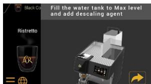
**Remarque importante** Retirez (le cas échéant) le filtre à eau du réservoir. Remplissez le réservoir d'eau jusqu'au niveau Max. avec de l'eau chaude, puis ajoutez le détartrant.
