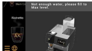
Wenn sich während des Entkalkungsvorgangs nicht genügend Wasser im Wassertank befindet, werden Sie durch eine Displaymeldung aufgefordert, den Wassertank nachzufüllen.
