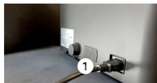
Sluit het netsnoer (1) aan op het apparaat en steek de stekker in een stopcontact.
